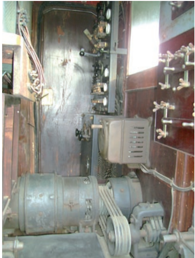
Carro Italiano: particolare dell'alternatore trifase sulla trasmissione
